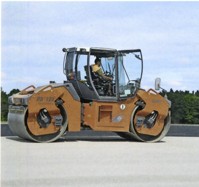
Der Fahrersitz in den Walzen der HD+ lässt sich bis zur Außenkante der Kabine verschieben und zu beiden Seiten um 90° drehen
